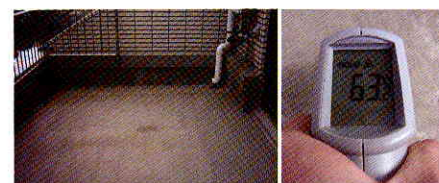
▲ガイナ塗布前のベランダのコンクリート表面温度は、63.2℃ (外気温33℃)。
